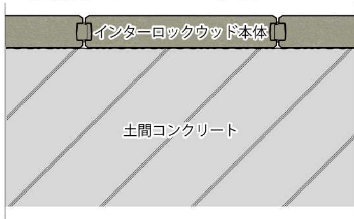
④土間コンクリートの上に直接
