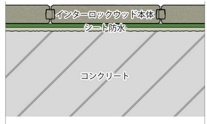
③屋上テラスの防水シート上納まり
