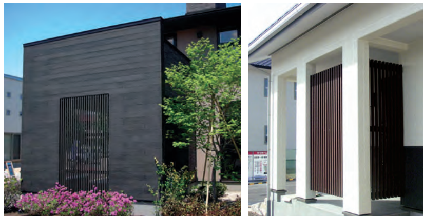
スクリーンの連続部は34mmの隙間を開けて施工します。スクリーンの横棧は連結しません。 40mm×80mm角のアルミ製梁材を開口部に取付けてからスクリーンを連続施工します。
