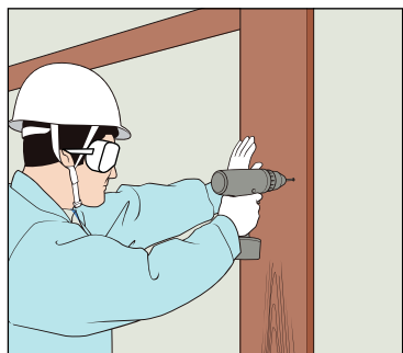
※インパクトドライバーは製品の破損の原因となります。電動ドライバーを使用してください。
