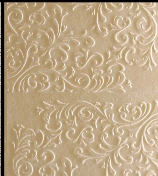
ケイカル板にマチエール仕上げ(厚さ≒0.3mm程度の仕上げ)
