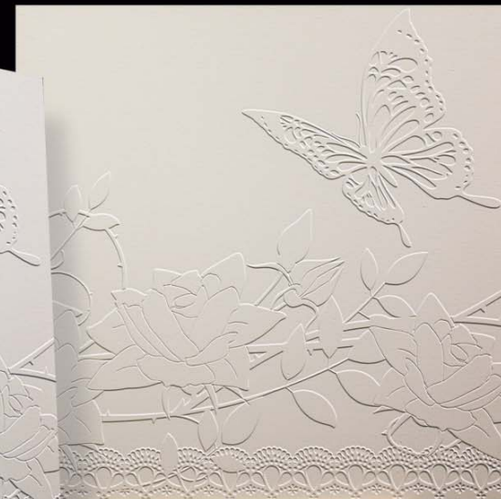
ケイカル板にマチエール仕上げ(厚さ≒0.3mm程度の仕上げ)
